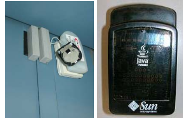
ユビキタスセンサ(左:開閉センサ 右:温度・照度センサ)
