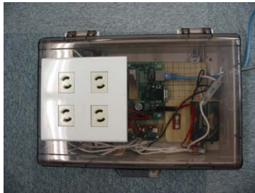
インテリジェントテーブルタップ
