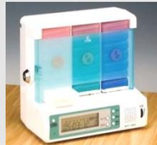
服薬時機が一定時間置き薬は、設定時刻に薬ケースを押し出したりLEDを点灯させたりすることにより支援できる
